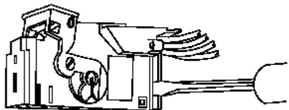
4.找到连接器后部的护盖锁舌。用小号平刃工具松开锁舌。对另一个锁舌重复上述程序。
